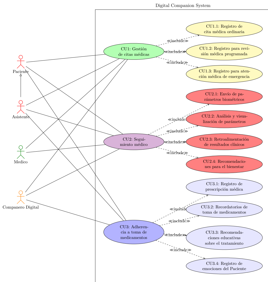
Figura 4.1: Diagrama de casos de uso para el sistema CoDiSPa
