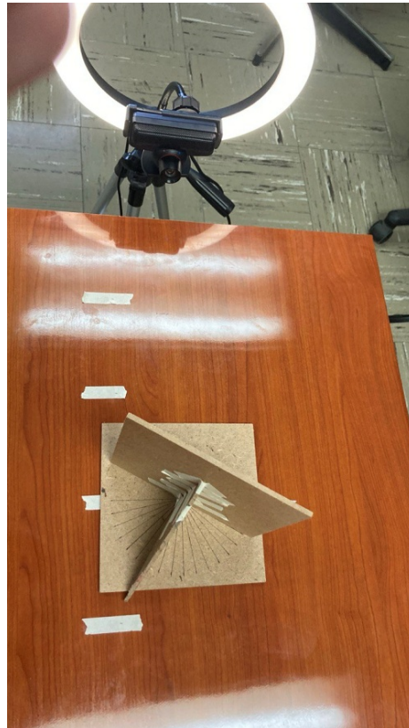
Figura 3.10: Tabla marcada con ángulos cada 10^\circ de 0^\circ a 180^\circ
