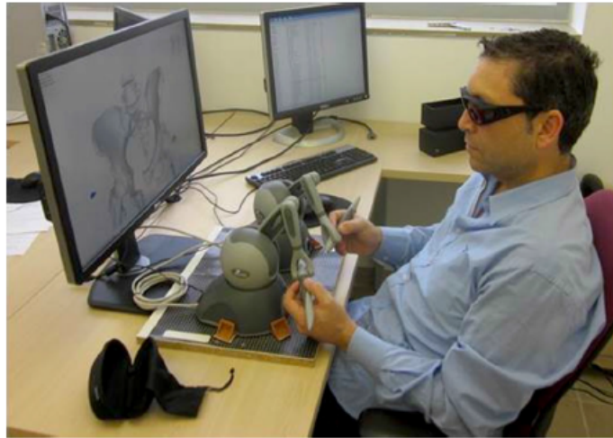
Figura 2.26: Sistema de planeación para el tratamiento de fracturas basado en dispositivo háptico [21].
