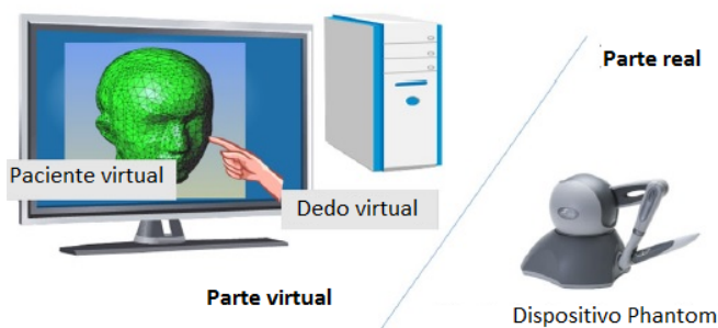
Figura 2.25: Simulación de palpación maxilofacial basada en dispositivo háptico [20].
