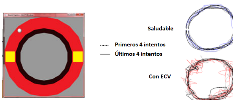
Figura 2.31: Videojuego de trayectoria circular para la rehabilitación de pacientes con ECV [26].
