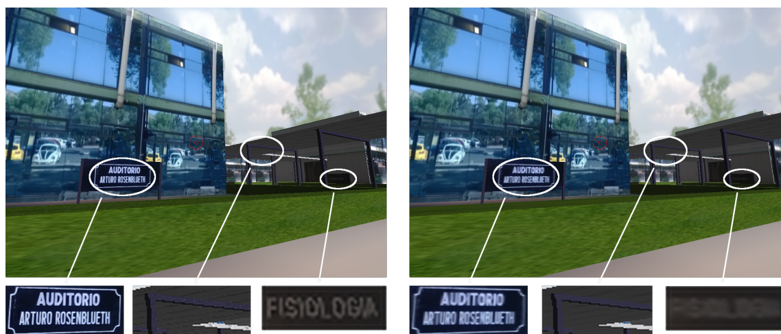
Figura 5.2: Los mapas MIP son texturas creadas previamente, mientras más lejano se encuentre algún objeto de la cámara se usará una versión de la textura de menor detalle. En el lado izquierdo se encuentra una escena texturizada con una única versión de las texturas, no importa si los objetos se encuentran lejos de la cámara, la imagen no perderá detalles. Del lado derecho se encuentra la misma escena pero los objetos son texturizados usando mapas MIP donde los objetos pierden detalle si están distantes de la cámara. Abajo de cada escena se encuentran los mismos elementos para su comparación.
