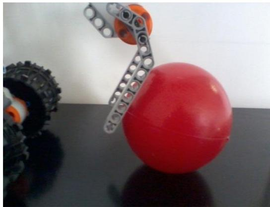
Figura 17.- Detalle de la garra incorporada al robot
