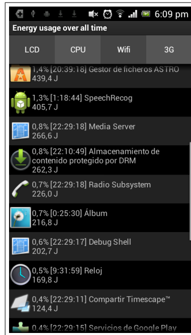
(b) Resultado de consumo de energía con procesamiento de voz por medio de funciones en C con JNI.
