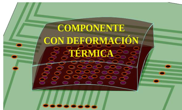
Figura 2.5: Ejemplo de cómo una deformación térmica de un componente SMD, con terminales debajo del encapsulado, puede afectar su conexión.
