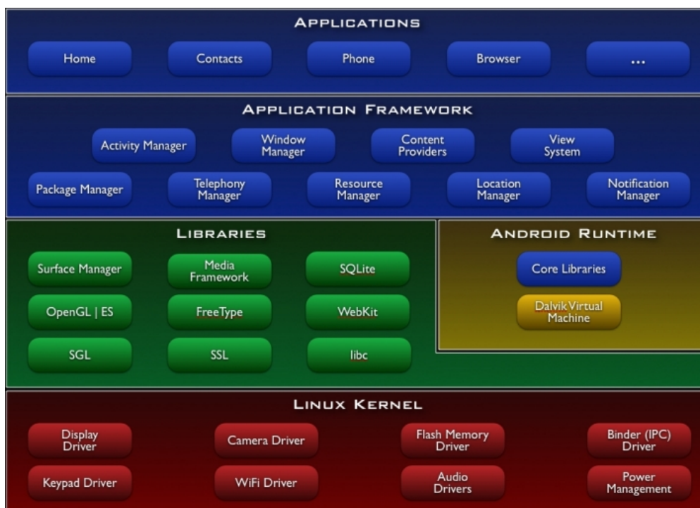
Figura 6.2: Principales componentes del Sistema Operativo Android
