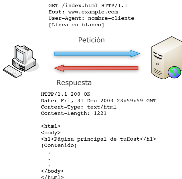
Figura 3.2: Funcionamiento del protocolo HTTP
