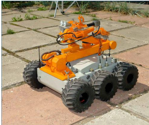
Figura 2. Robot móvil de seis ruedas con diferentes grados de libertad.
