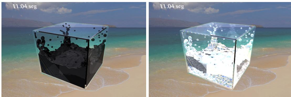
Figura 4.7: Caja redondeada y fluido juntos. A la izquierda se tiene el nivel de recursión por defecto. A la derecha se ha incrementado a un valor de 15.
