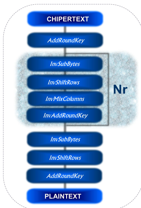
Figura 2.6: Algoritmo de descifrado AES
