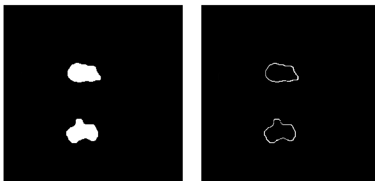
Figura 6.14: Perímetro de una imagen binarizada perteneciente a una soldadura.
