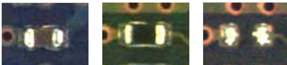
Figura 3.2: La imagen de la izquierda es de un capacitor, la imagen del centro es una resistencia y la imagen de la derecha muestra soldaduras de la base sin presencia del elemento.
