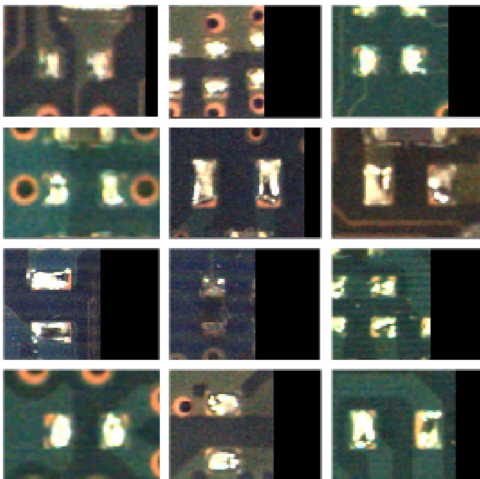
Figura 8.6: Soldaduras en el conjunto de pruebas de 945 elementos.
