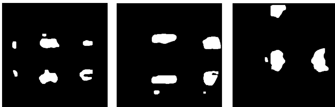
Figura 6.1: En las imágenes de la izquierda y derecha se muestran objetos con momentos invariantes similares soldaduras de capacitores y resistencias. En la imagen central se describen objetos con momentos invariantes pertenecientes a extremos de capacitores y resistencias.
