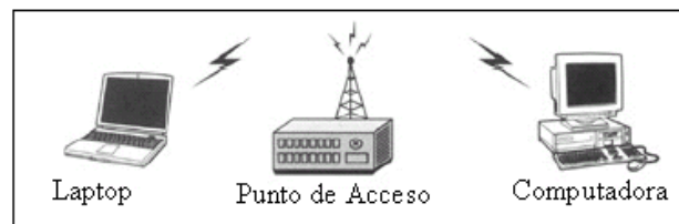
Figura 2.2: Red inalámbrica en modo Infraestructura
