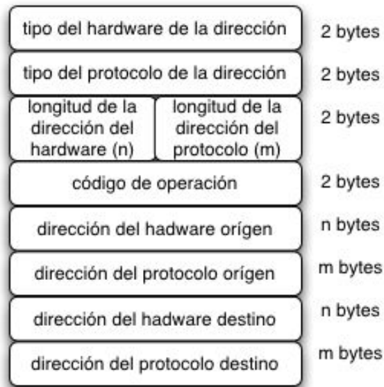
Figura 3.3: Formato de un mensaje ARP
