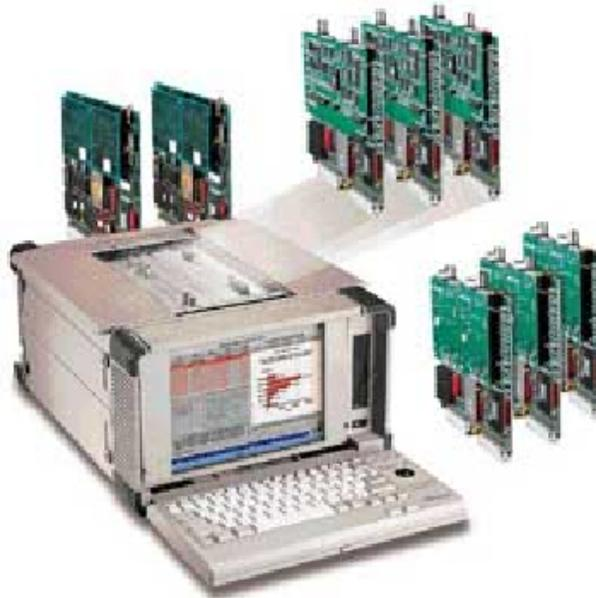
Figura 3.1: Equipo NavTelIW96000, con sus aditamentos.
