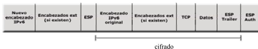
Figura 5.5. Paquete IPv6 con ESP en modo Túnel
