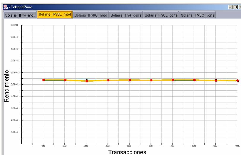
Figura 4.20 Rendimiento de IPv6 plataforma Solaris realizando operaciones de modificación mediante el mecanismo dual-stack
