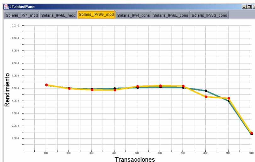
Figura 4.19 Rendimiento de IPv6 plataforma Solaris realizando operaciones de modificación mediante el mecanismo tunnel-broker
