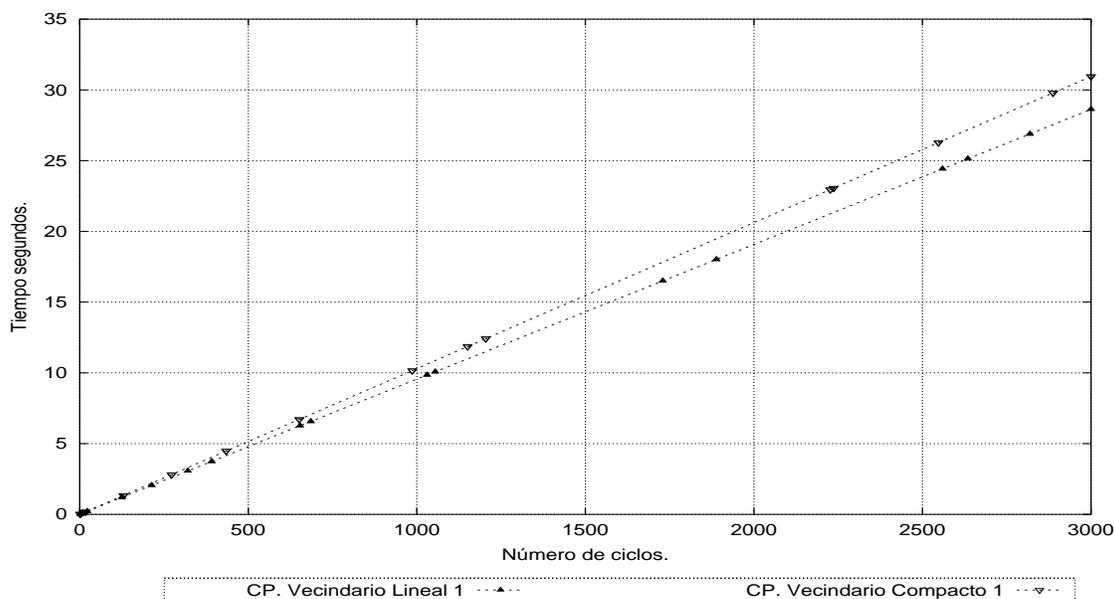
Figura 5.28: Tiempos requeridos por la simulación del AG de grano fino paralelo (8 procesadores)
