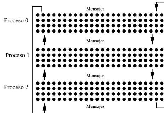
Figura 4.9: Intercambio de cromosomas en el modelo de grano fino paralelo.
