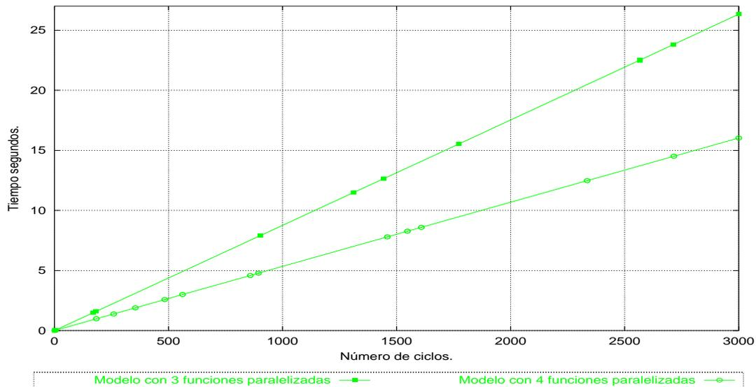
Figura 5.7: Tiempo requerido por los AGs con modelo global usando 4 procesadores.
