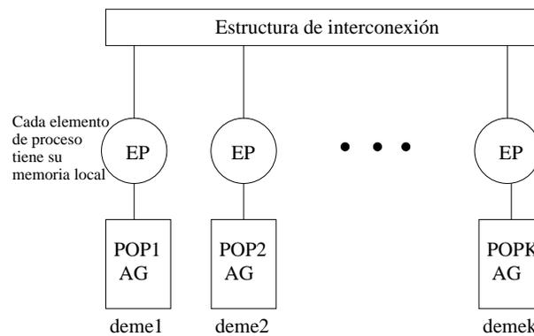
Figura 2.4: Modelo de paralelización de grano grueso para un AG, donde, *EP*-Elemento de proceso, *POP<sub>k</sub>*-Población del *EP<sub>k</sub>*
