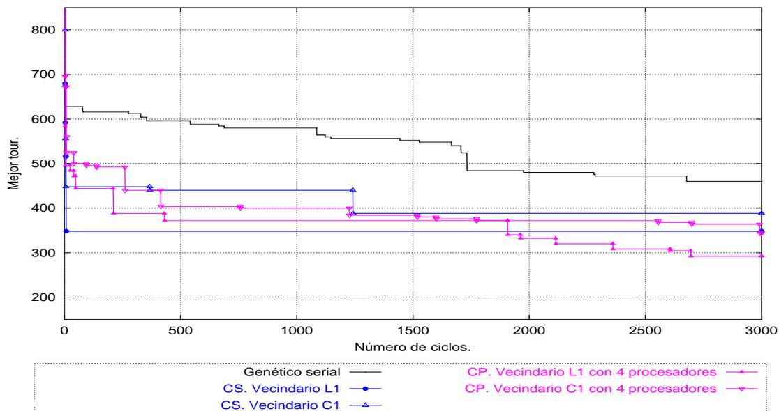
Figura 5.20: Resultados de la simulación del AG de grano fino serial y paralelo con 4 procesadores.
