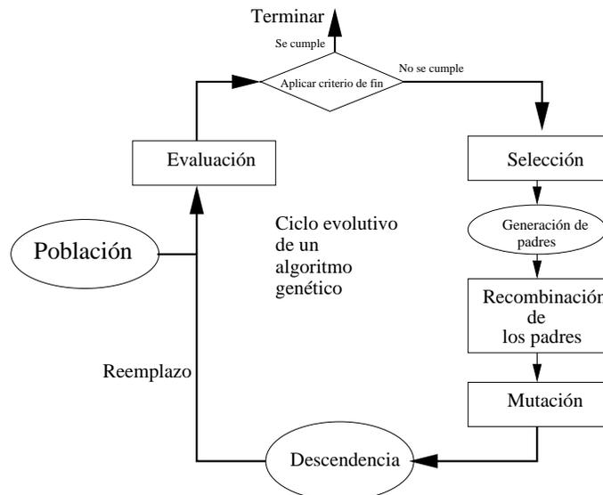
Figura 1.1: Diagrama de un AG convencional.
