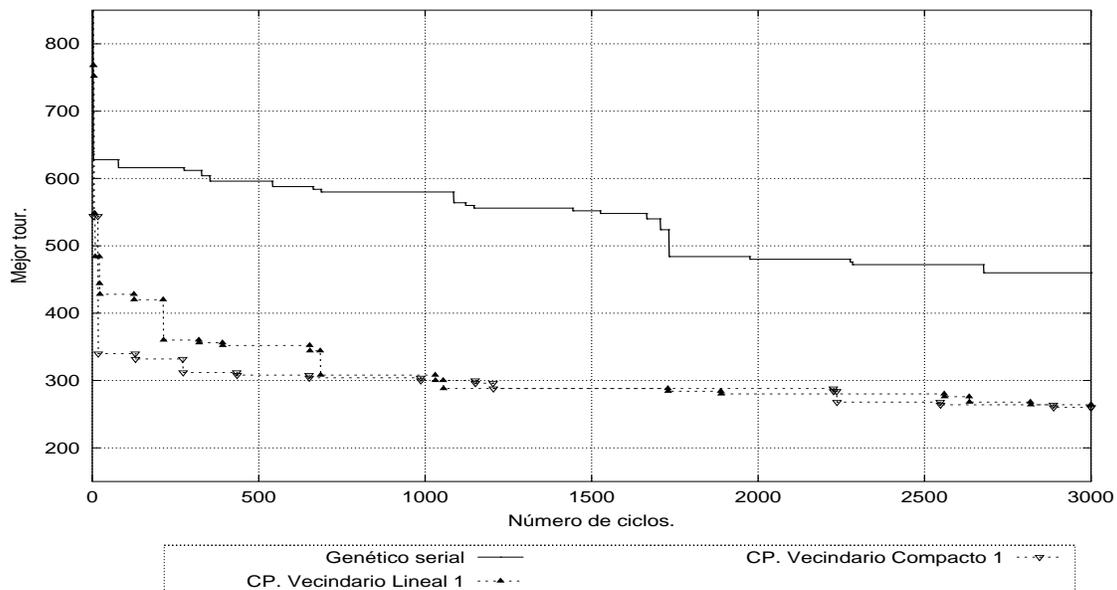
Figura 5.25: Resultados de la simulación del AG de grano fino paralelo con 8 procesadores.
