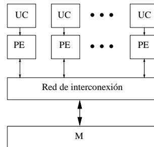
Figura 2.1: Arquitectura MIMD con memoria compartida, donde, UC-*unidad de control*, PE-*Elemento de proceso* y M-*Memoria compartida*
