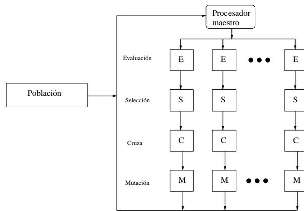
Figura 2.3: Modelo de paralelización global para un AG.
