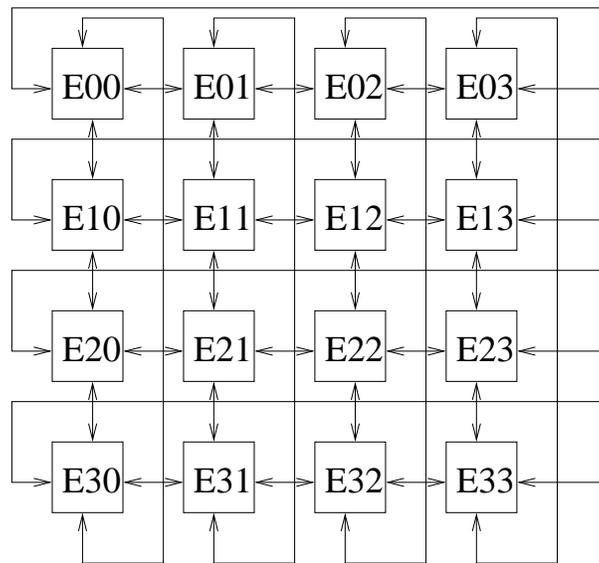
Figura 4.7: Estructura general de un AG de grano fino.
