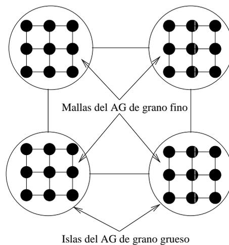
Figura 2.9: Esquema híbrido donde se combina un AG de grano grueso a alto nivel con un AG de grano fino a bajo nivel.
