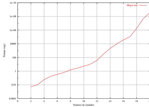
Figura 3.2: Tiempo requerido por un algoritmo convencional para resolver el TSP.
