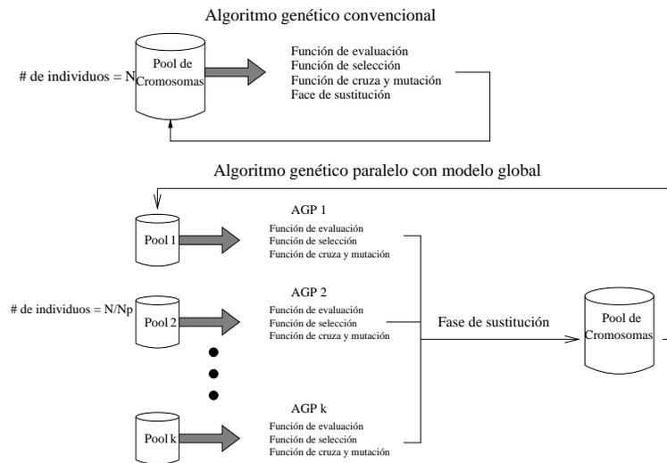
Figura 4.4: Proceso de ejecución del AGP global.
