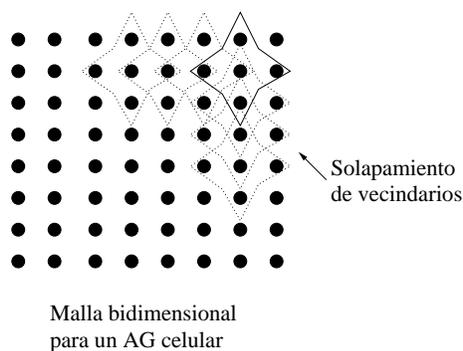
Figura 2.8: Solapamiento entre vecindarios dentro de una malla bidimensional.
