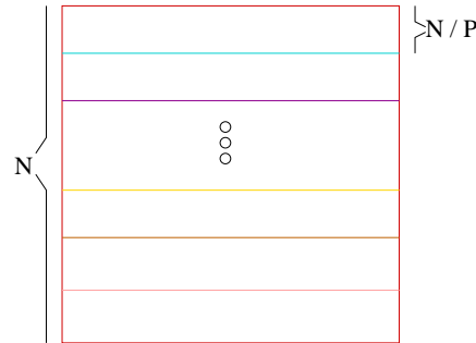
Figura 5.2: Estrategia de particionamiento para la etapa de interacción de los perceptrones. Particionamiento por Bloques.
