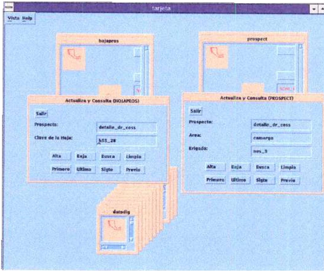
Figura.4-8 Se abre la tarjeta “Actualización y Consulta” de Hojapros y Prospecto para meter los datos nominal para generar un nuevo plano base
