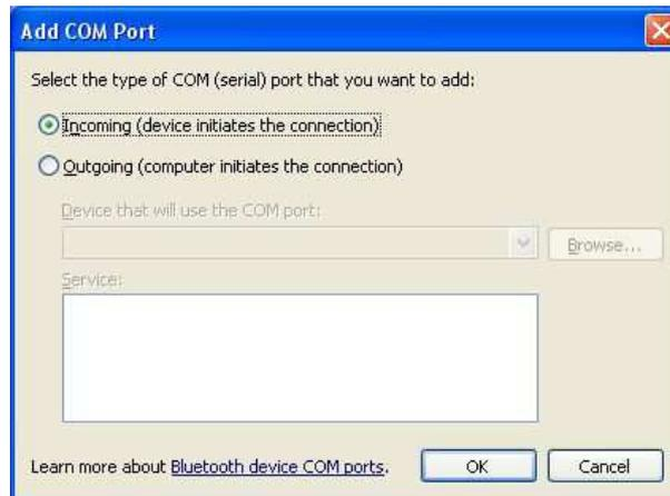
Figura 3.17: Agregación de un puerto COM virtual a la pila de Bluetooth de Windows XP
