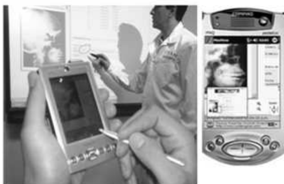
Figura 2.4: Uso de un despliegue público por medio de telepunteros y un PDA
