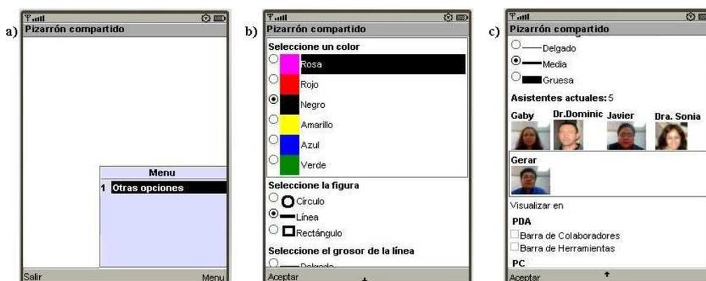
Figura 4.4: Primer prototipo de la interfaz de usuario para la PDA, a) la ventana principal muestra el área de dibujo, mientras que b) la barra de herramientas así como la meta-interfaz de redistribución y la barra de colaboradores se despliegan en una ventana secundaria
